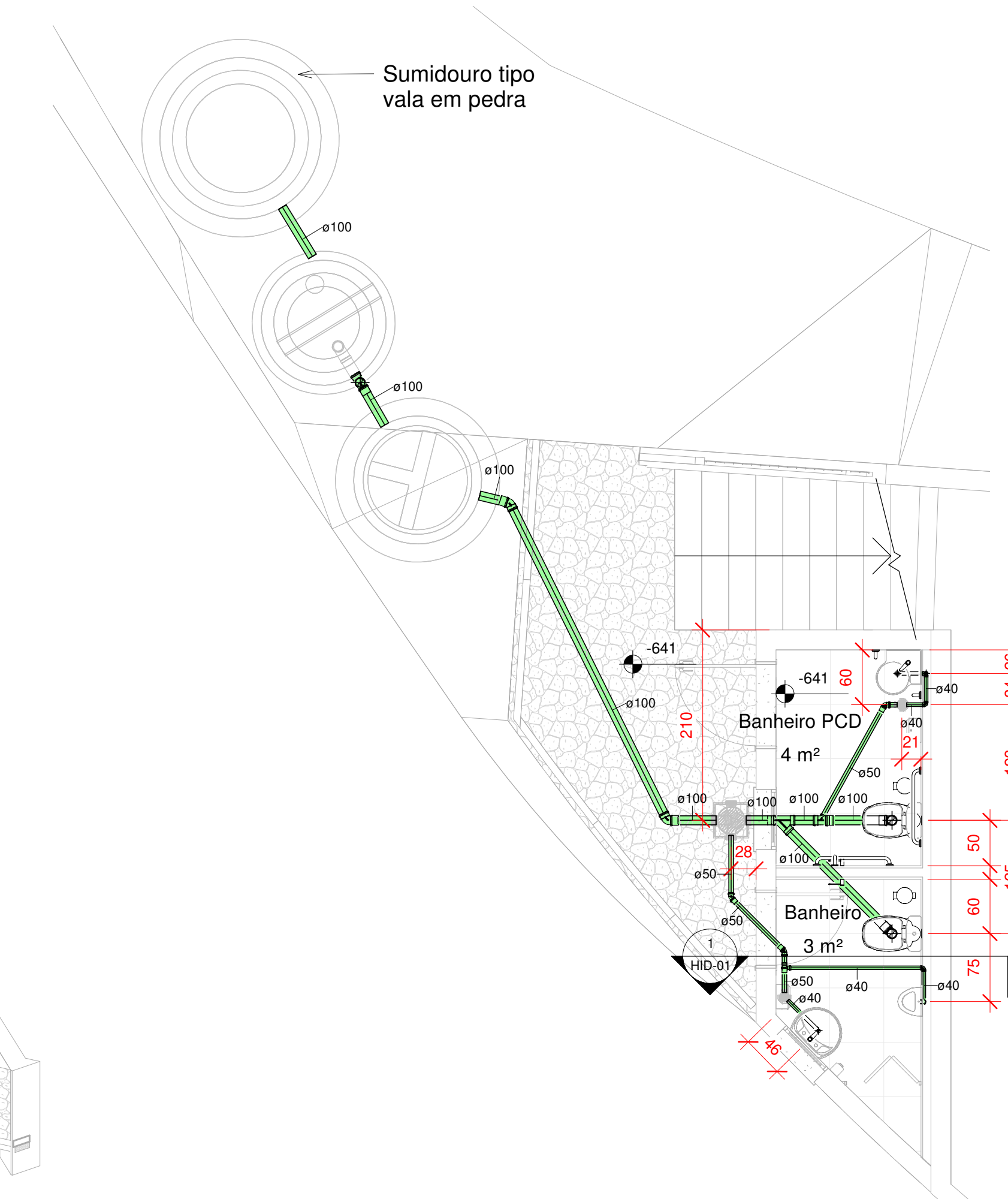
2 Planta baixa Banheiros - Esgoto 1 : 50
