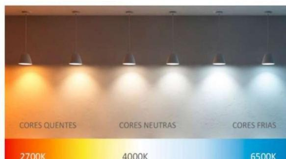
No quadro acima encontram-se alguns exemplos da temperatura de cor e respetiva aparência [EDP, 2010]. (KALTHOUM, KHULOUD. Distorção harmónica causada pelos LEDs em iluminação pública - análise e proposta de soluções, 2016)
