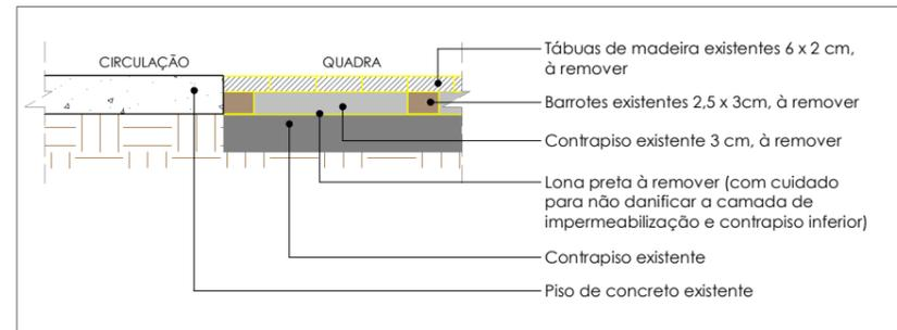
Detalhe de piso - à remover | ESCALA: 1 : 10
