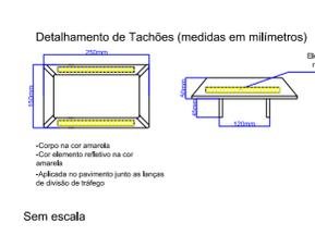
**Detalhamento Separação de Fluxo**
