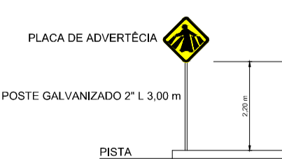
06 Detalhe Fixação de Placas Sem Escala
